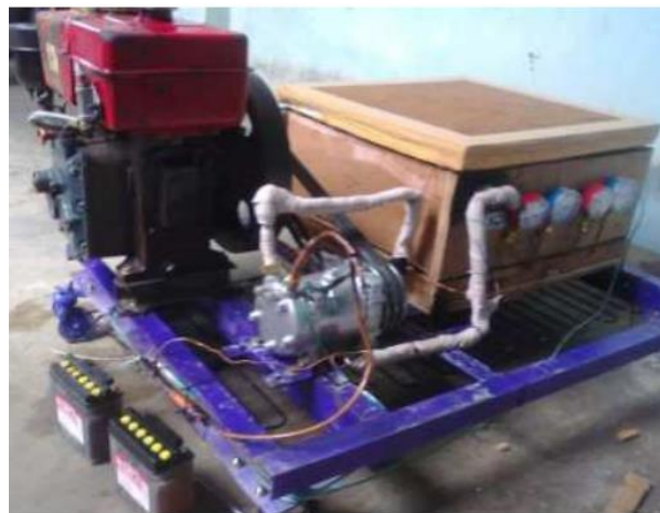
Gambar 2. Contoh Model mesin pendingin ikan
